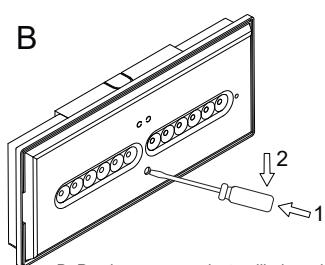
B- Presionar con un destornillador sobre la pestaña.
