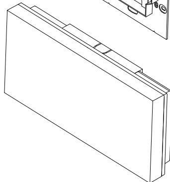
La luminaria se compone de una pre-placa de fijación y de una envolvente que contiene electrónica y baterías.
