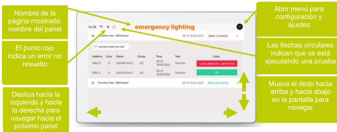
Figura 4. Interfaz de Usuario para Control de luminarias con la central DALI Configuración y puesta en marcha del sistema DALI, consulte la página 8. Programaciones de pruebas, consulte la página 11. Interfaz de usuario, consulte la página 13 y siguientes
